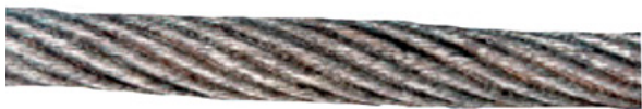
Figure D.17 - Augmentation locale du diamètre du câble due à l'extrusion de l'âme
