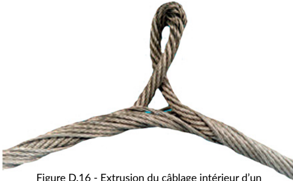
Figure D.16 - Extrusion du câblage intérieur d'un câble antigiratoire
